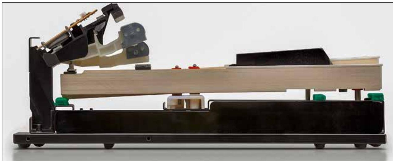
Устройство механизма цифрового фортепиано
