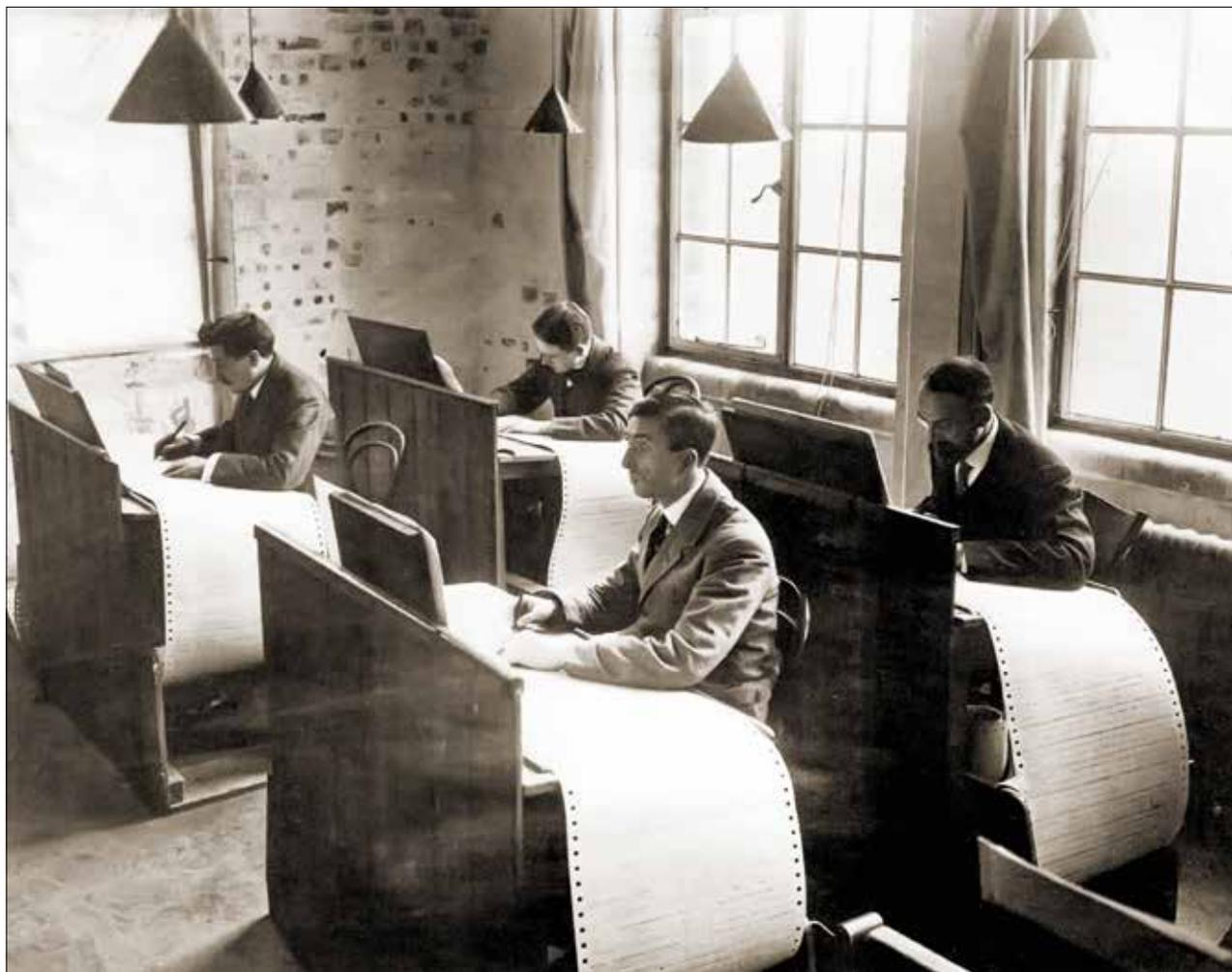
Проверка перфорированных рулонов для механизма пианолы
