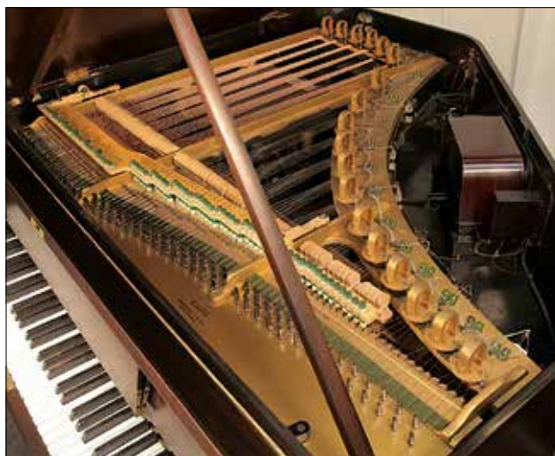
Внешний вид «Neo-Bechstein» и фотография струн с электростатическими датчиками.
