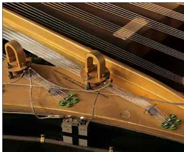
Внешний вид «Neo-Bechstein» и фотография струн с электростатическими датчиками.
